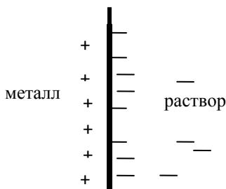
Рис. 11. Двойной электрический слой на границе раздела малоактивный металл - раствор
